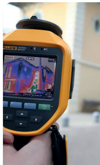
Nos conseillers analysent les pertes de chaleur des bâtiments à l'aide d'une caméra thermique.
