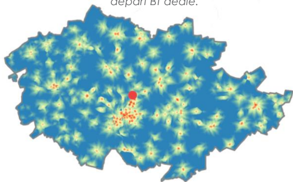
Puissance injectable par création d'un départ BT dédié.
